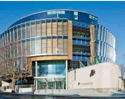
Помимо базовых и дизайнерских серий Schüco предлагает специальные решения для изготовления теплоизолированных оконных фасадов. С помощью оконных систем Schüco можно реализовать визуально однородные оконные фасады с высотой в этаж с имитацией стоечно-ригельной конструкции.
